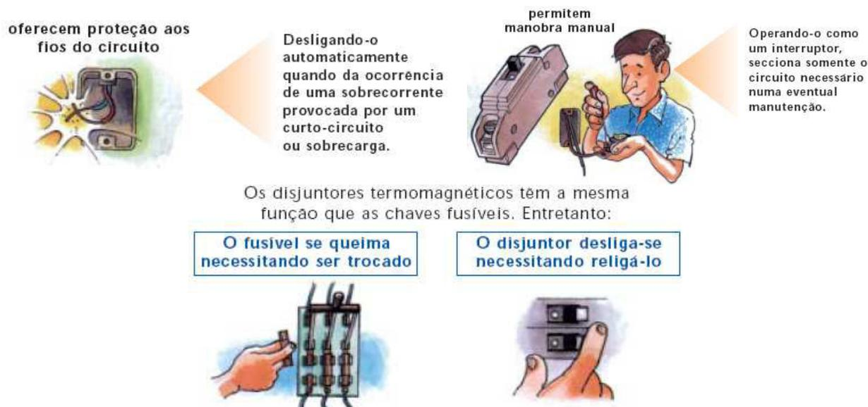
Fig. 2.11. Características do disjuntor termomagnético
